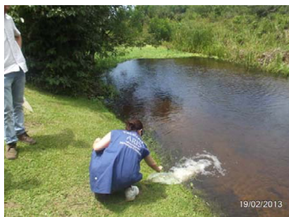
Imagem 45: Análise de turbidez na descarga de rede. Foram coletadas duas amostras.
