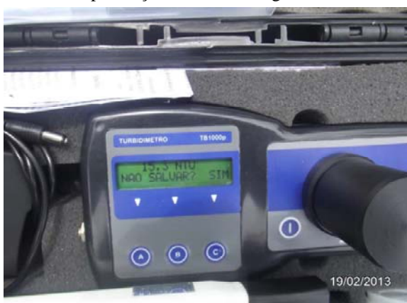
Imagem 46: Análise de turbidez na descarga de rede. Resultado da primeira amostra: 15,2 NTU.
