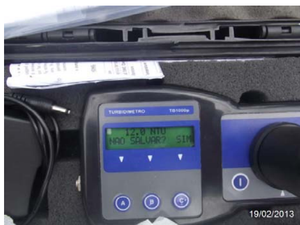
Imagem 47: Análise de turbidez na descarga de rede. Resultado da segunda amostra: 12,0 NTU.
