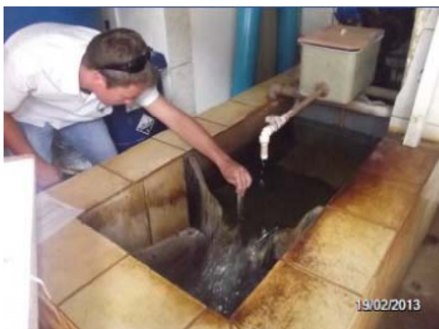
Imagem 5: Medição de vazão de forma rudimentar, utilizando uma régua escolar de 30 cm.
