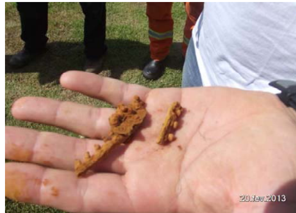
Imagem 83: Borra da incrustação do interior da tubulação. Cor e aspecto de ferro oxidado.
