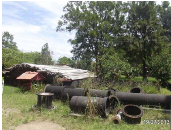
Imagem 39: Material inoperante armazenado sem proteção e exposto a intempéries.
