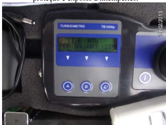
Imagem 43: Análise de turbidez na saída do tratamento, medido 3,6 NTU. Está em desacordo com a Portaria/MS n. 2.914/2011.
