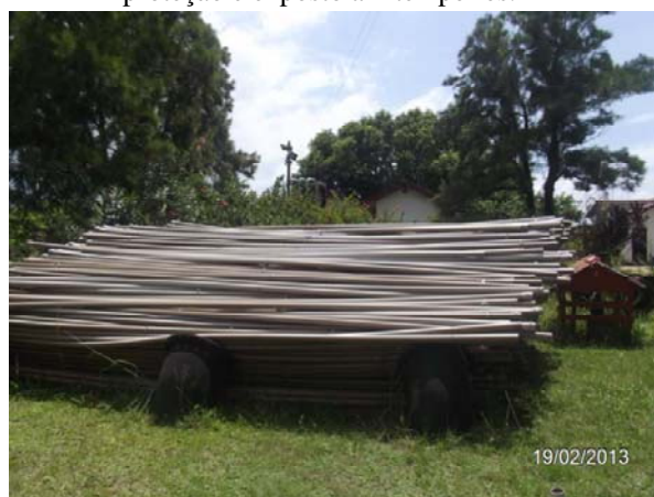
Imagem 41: Material inoperante armazenado sem proteção e exposto a intempéries.
