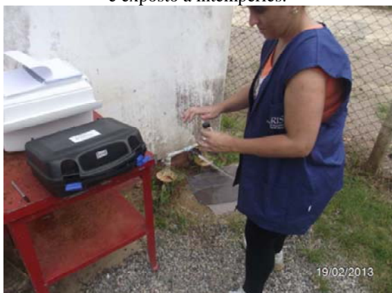
Imagem 42: Análise de turbidez na saída do tratamento.
