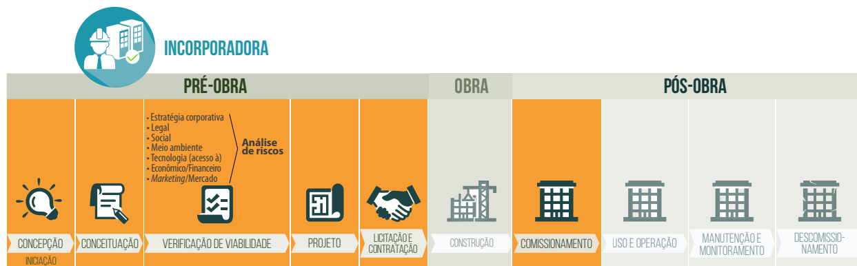
Figura 11: Ciclo de vida típico de um empreendimento, com destaque para as fases que estariam no foco de interesse de uma incorporadora
