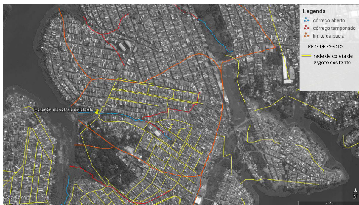
Figura 6 – Rede coletora de esgoto existente, como indicação de estação elevatória. Elaborado a partir de bases de < http://gestaourbana.prefeitura.sp.gov.br >.
