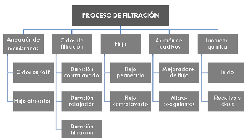
Figura 6.62 Puntos de control del proceso de filtración de un MBR (Ferrero et al, 2012)
