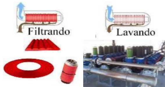
Figura 5.7 Filtros de anillas. Dcha.) Ranuras de la anilla Izda.) Anilla y Elemento filtrante
