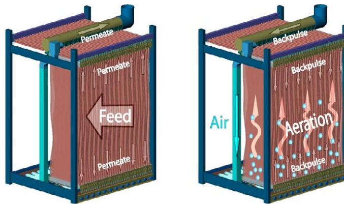
Figura 6.11 Sistema de aireación del sistema Zenon
