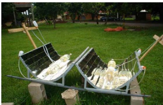
Figura 1: Concentradores Solar Parabólico
