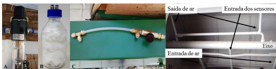
Figura 11: Da esquerda para a direita: A) Regulador de pressão. B) Filtro (frasco reagente+algodão). C) Válvula Reguladora. D) Sistema de entrada e saída de ar.
