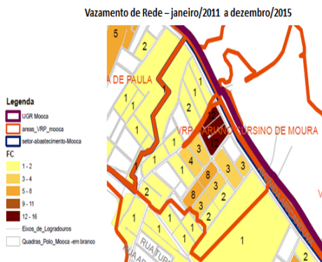
Figuras 9 e 10: Exemplo de mapa temático de ocorrências e gráfico demonstrando a eficiência da obra com diminuição de 70% na vazão mínima noturna após o término dos serviços.
