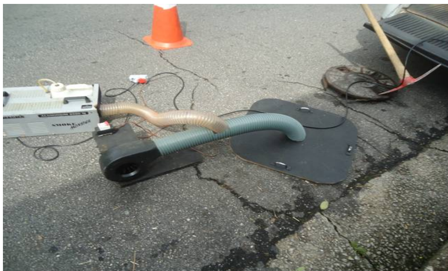
Foto 05 – Equipamento de Teste de Fumaça.
