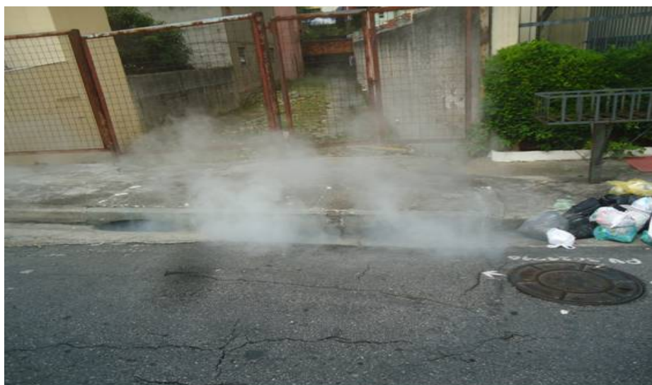
Foto 06 – Fumaça em Bocas de Lobo, durante teste.
