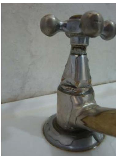
**Figura 7 – Exemplo de torneira com falta de estanqueidade na região do castelo**
