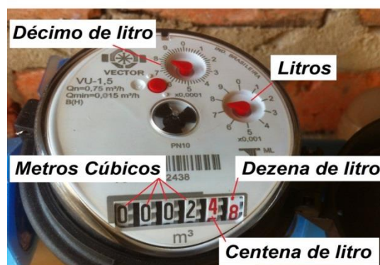
Figura 5 – Exemplo de leitura no hidrômetro instalado
