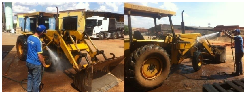
Figura 7 – Limpeza de Pá Carregadeira
