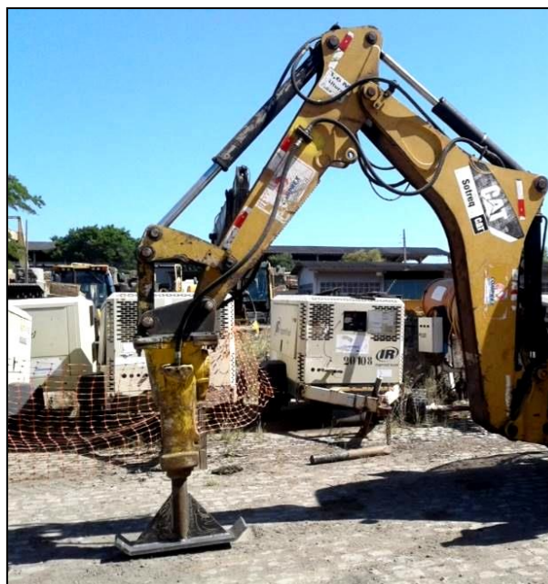
Figura 4 – Retroscavadeira com martelo hidráulico adaptado.
