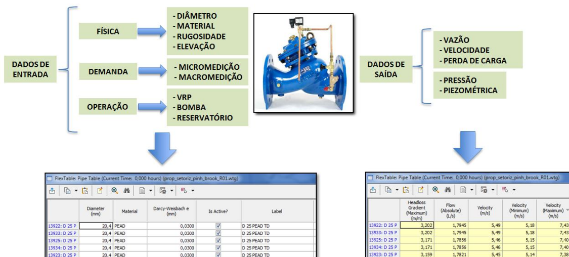
Figura 2 – Dados de entrada e de saída da ferramenta de simulação hidráulica.
