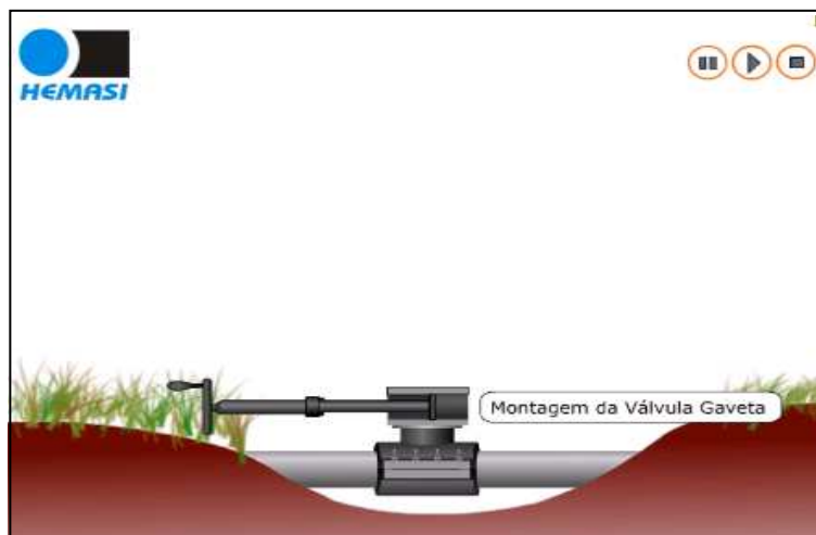
Figura 9 : Montagem da válvula Gaveta.
