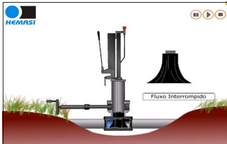
Figura 12 : Interrupção de fluxo com elastômero.
