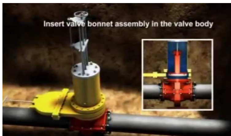
Figura 21 : Cabeçote sendo instalado no corpo da válvula por ferramenta de inserção.
