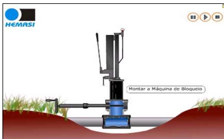
Figura 11 : Montagem da máquina de bloqueio.
