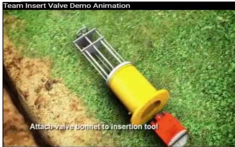
Figura 20 : Cabeçote de válvula gaveta sendo inserida na ferramenta de inserção.
