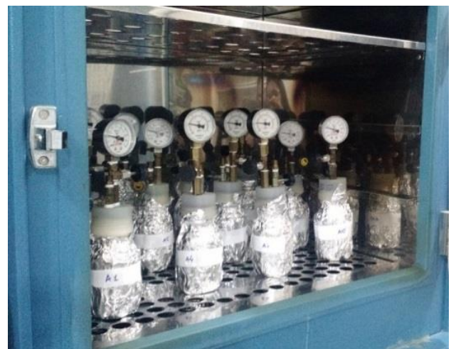
Figura 1. Biodigestores do ensaio BMP acondicionados em estufa.
