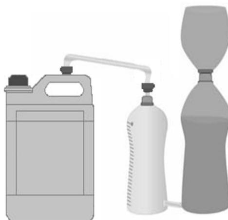
**Figura 1: Biodigestor (à esquerda) e sistema de medição (frasco graduado ao centro e reservatório à direita).
