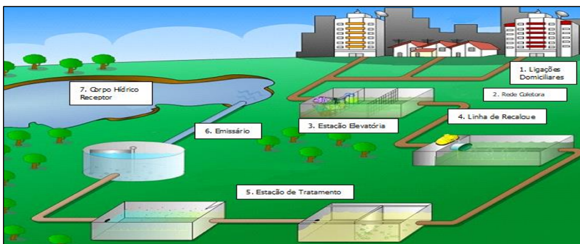
Figura 2. Sistema de Tratamento de Esgoto.
