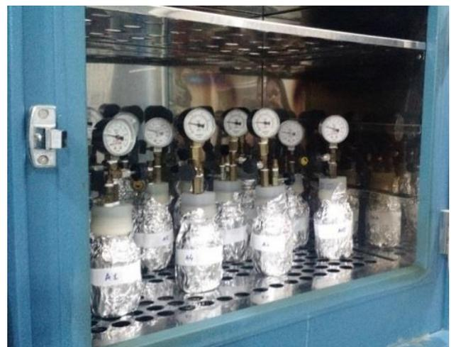
**Figura 1.** Biodigestores do ensaio BMP acondicionados em estufa.
