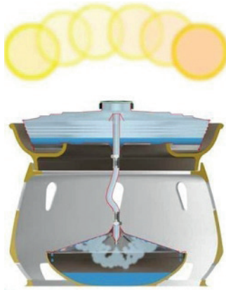
Figura 11 – Esquema da destilação solar. Fonte: Dessalinizadores e seus sensores.
