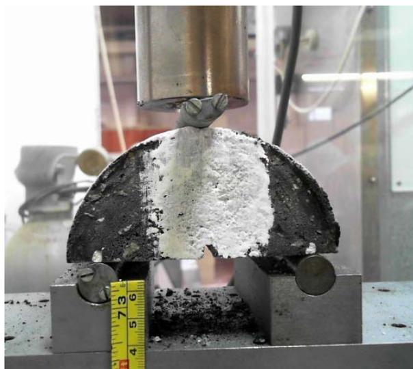
Figura 46 - Colocação do provete CF1A no ensaio de fratura SCB
