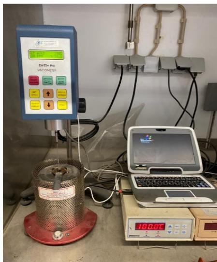
Figura 27 - Equipamento utilizado no ensaio de viscosidade dinâmica
