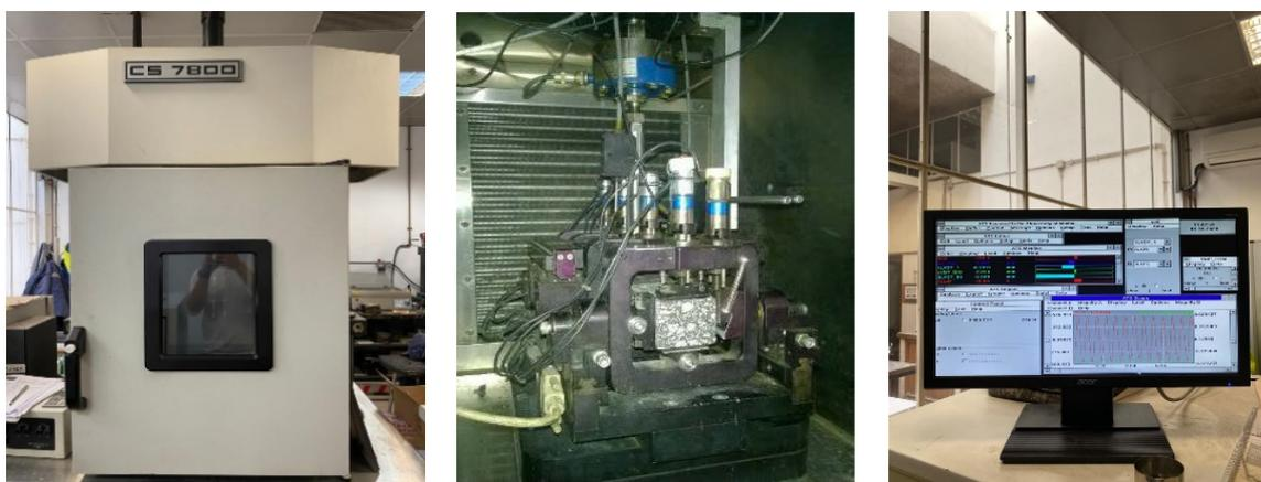
*Figura 43 - Equipamento usado para a realização dos ensaios de fadiga e módulo de rigidez*
