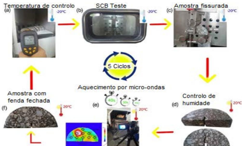
Figura 18 - Esquema dos procedimentos adotados no estudo de adaptado de Fakhri et al. (2020)
