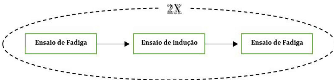
Figura 45 - Procedimento adotado para calcular o nível de regeneração (HL - Healing Level) das vigas após fadiga
