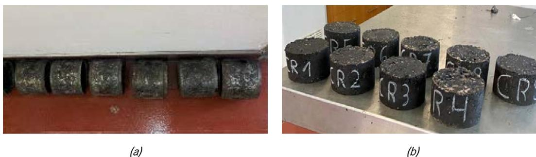
Figura 34 - Provetes cilíndricos (a) antes e (b) depois de serem desmoldados
