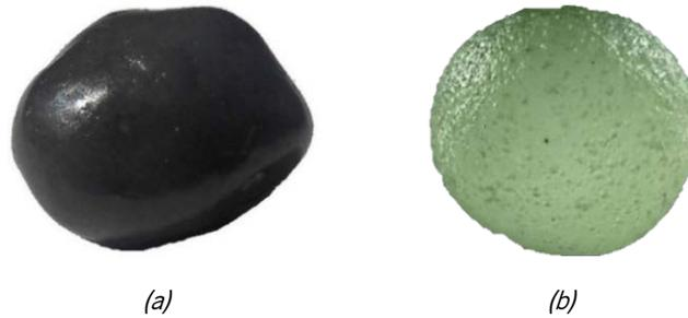
Figura 19 - Exemplo de cápsulas rejuvenescedoras: (a) Cápsula com óleo de girassol e outros constituintes (2 mm) (Garcia *et al.*, 2015); (b) Cápsula de alginato de cálcio (0,5 mm) (Al-Mansoori *et al.*, 2018).
