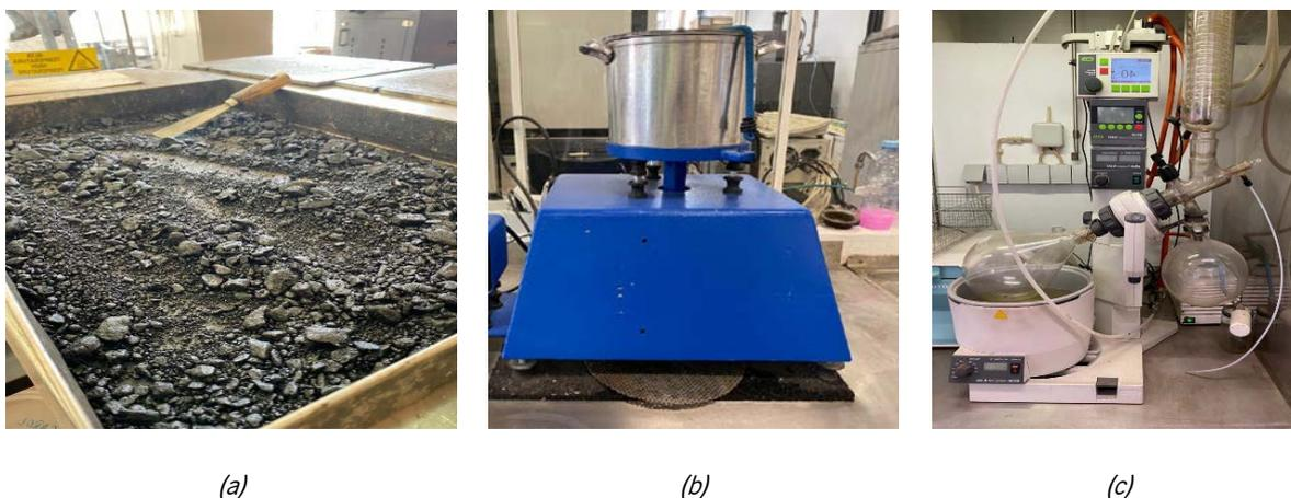
Figura 39 - (a) Amostra de mistura betuminosa desagregada; (b) Picnómetro; (c) Equipamento de vácuo.
