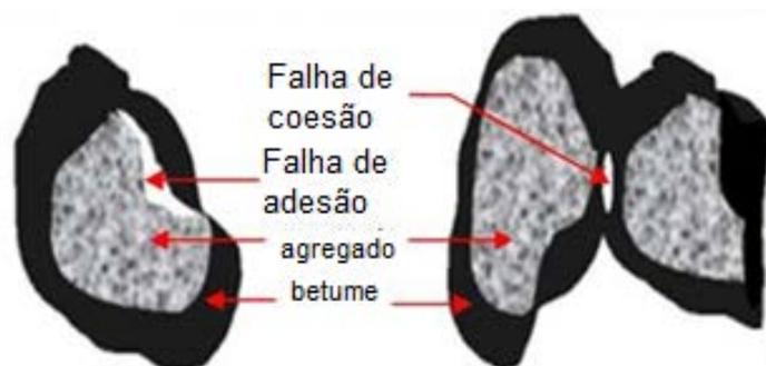
Figura 12 - Tipos de forças (adesão e coesão) que ocorrem numa mistura betuminosa (adaptado de Guo et al., 2017)
