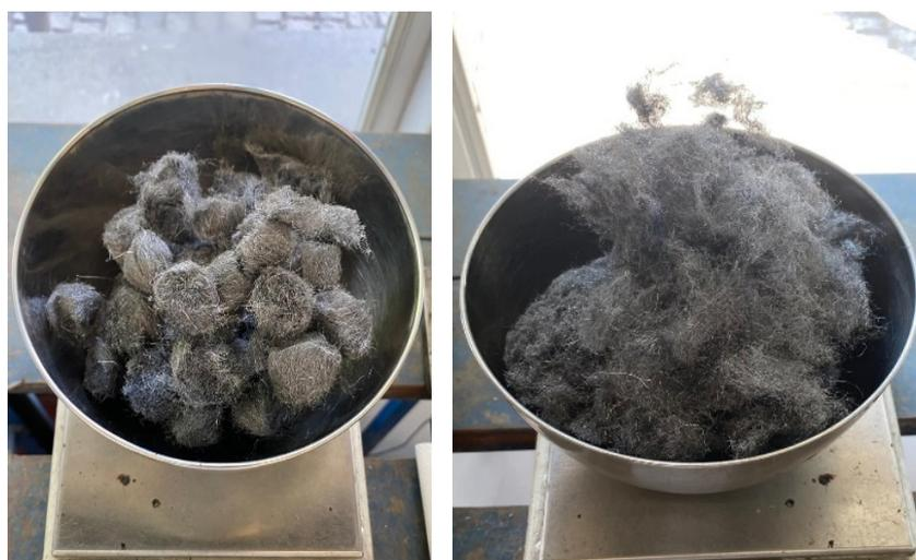
*Figura 32 - Fibras de lã de aço cortadas para introdução nas misturas*
