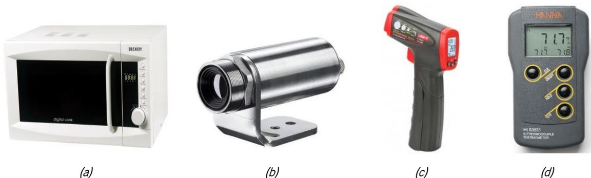
Figura 40 - Equipamentos utilizados para indução e medição das temperaturas das misturas betuminosas
