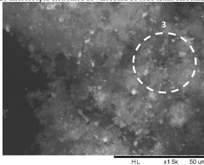
A estrutura do material precursor (LT) é densa e não são observados muitos poros, conforme mostra a Figura 1. Observando-se com a Figura 2, após a carbonização, verifica-se a presença de poros de diferentes tamanhos e formas na superfície do lodo têxtil carbonizado, devido à decomposição da matéria orgânica durante o processo de carbonização.
