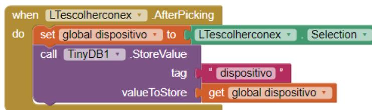
Figura 27 – Bloco para gravar seleção de dispositivos
