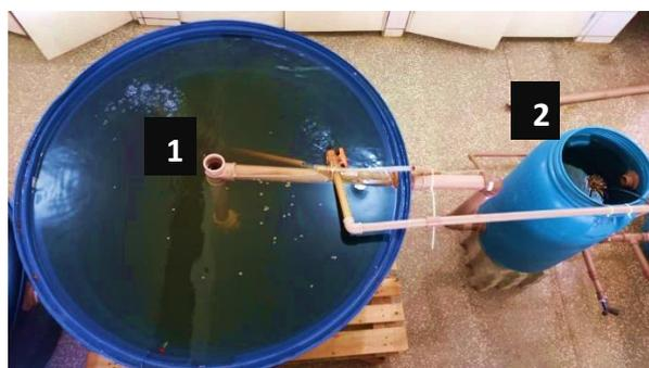
**Figura 4** - Dreno central do tanque de cultivo onde ocorrerá sucção das partículas de sólidos que serão transportadas ao decantador.
