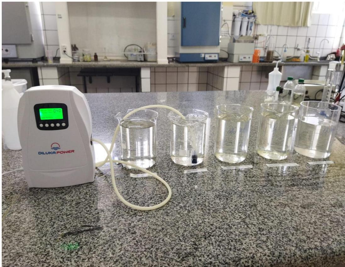
**Figura 8** - Gerador de ozônio para ensaio em diferentes tempos.
