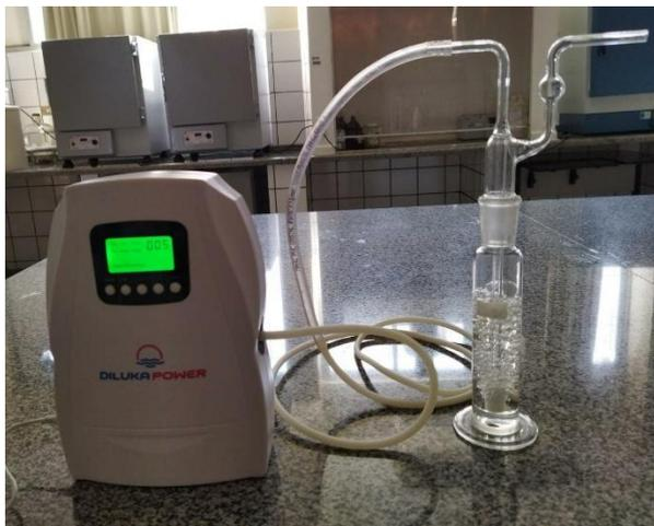
**Figura 10** - Tratamento em um frasco lavrador de gases.
