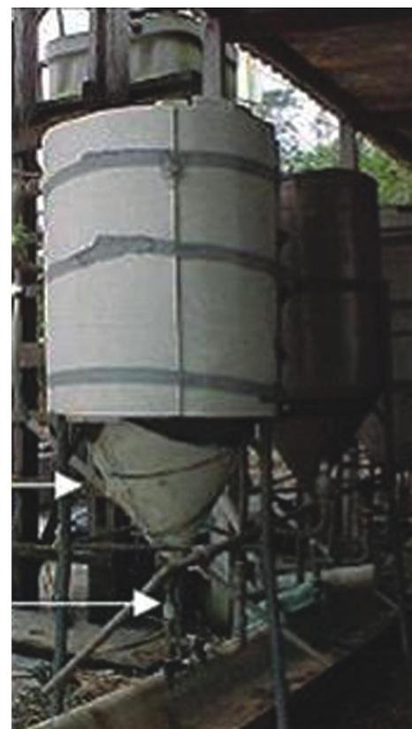
Figura 5. Reator anaeróbio com recheio de bambu. Fonte: Ronaldo Stefanutti.
