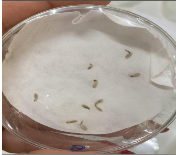
Figura 1: Unidade experimental, na qual sementes de Lactuca Sativa (alface) foram inseridas em placa de petri, acima de papel-filtro embebido com amostra-teste (água deionizada, esgoto bruto ou esgoto trabalho).
