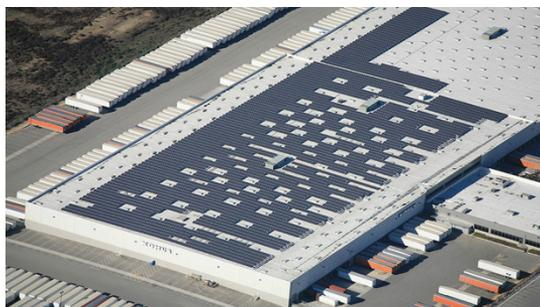
**Figura 3.14** Exemplo de minigeração de sistema fotovoltaico conectado à rede.
