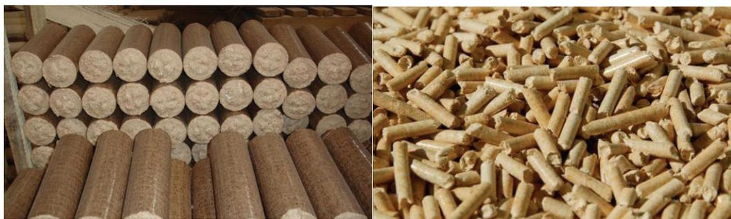
**Figura 5.3** Briquetes (foto à esquerda) e péletes (foto à direita).
