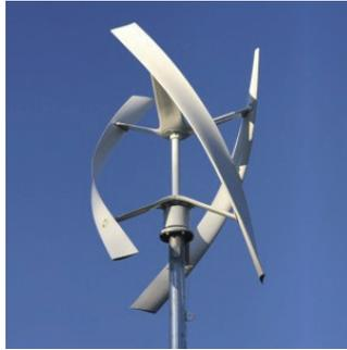
**Figura 4.11** Turbina eólica de eixo vertical.
