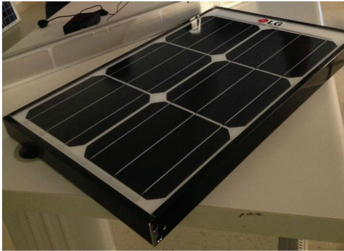
**Figura 3.3b** Placa de silício monocristalino.
