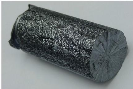
**Figura 3.4a:** Lingote de silício policristalino.
