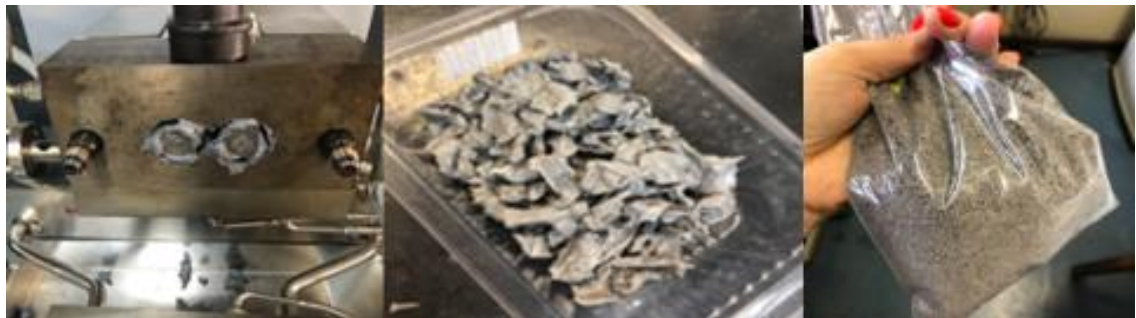
Figura 10 – Câmara de mistura da Haake (esquerda), amostras que saem da câmara após a mistura (central) e amostras cominuídas em mini moinho de bancada (direita).
