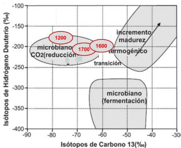
**Figura 4.** Composición isotópica (carbono 13 vs deuterio) a partir de muestras de CBM de la zona de Cesar (El Paso), para determinar si el origen es microbiano o termogénico. Fuente: Adaptado de (2, 26)
