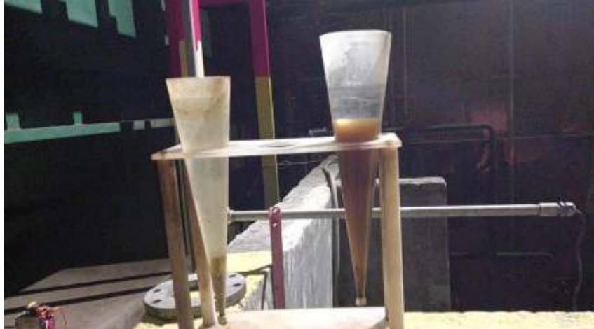
Figura 8 – Medição do residual de sólidos do decantador.
