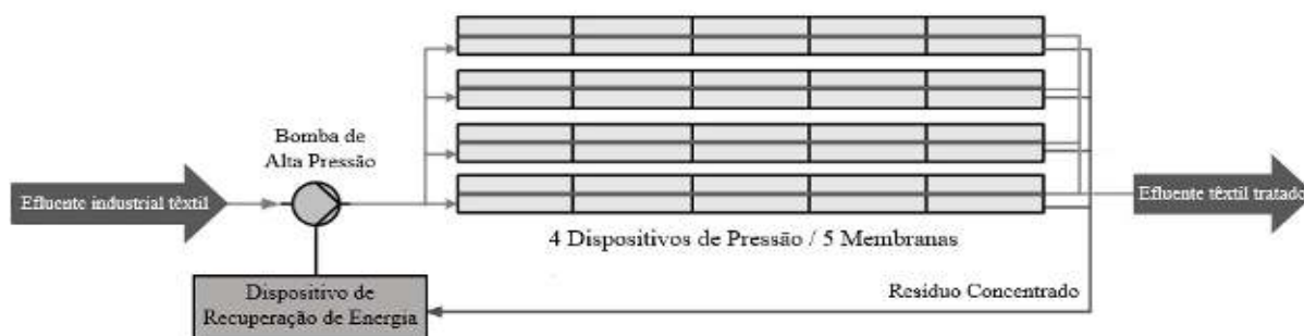
Figura 8 – Módulo de OR à nível industrial para tratamento de efluente têxtil
