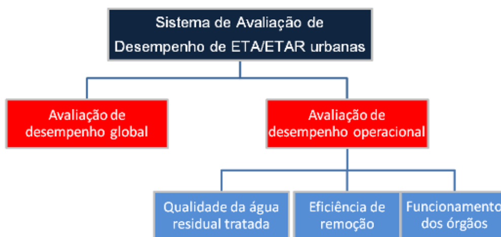
Figura 1 Sistema de avaliação de desempenho de ETAR (adaptado de Vieira et al. , 2009).
