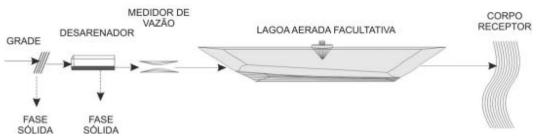
Figura 6 – Fluxograma típico de um sistema de lagoa aerada facultativa
