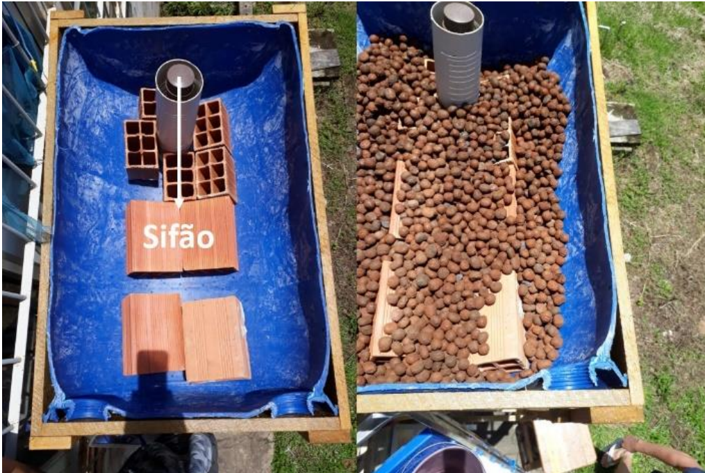
Figura 11 - Detalhes da montagem do leito de hortelã (S5). Fonte: Autor.
