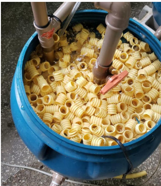
Figura 8 - Conduítes usados como biomídias alternativas. Fonte: Autor.
