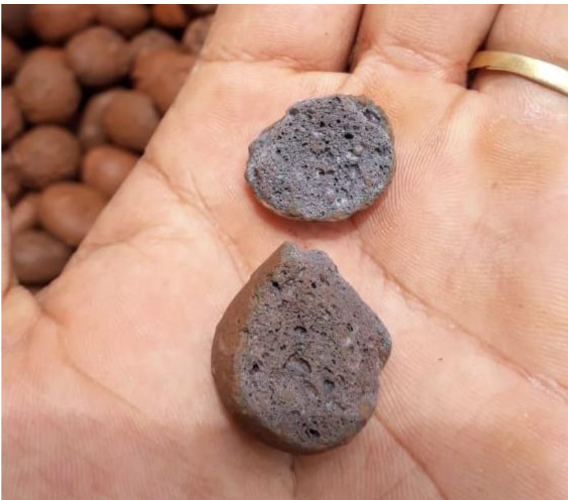
Figura 12 - Poros no interior da argila expandida utilizada no preenchimento do S5. Fonte: Autor.
