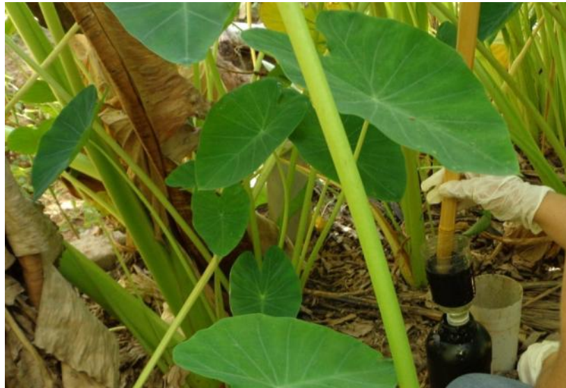
Figura 7.3. Coleta de efluente de dentro da BET (tubo de visita de PVC 100 mm), com auxílio de uma garrafa plástica cortada e amarrada a um pedaço de bambu.
