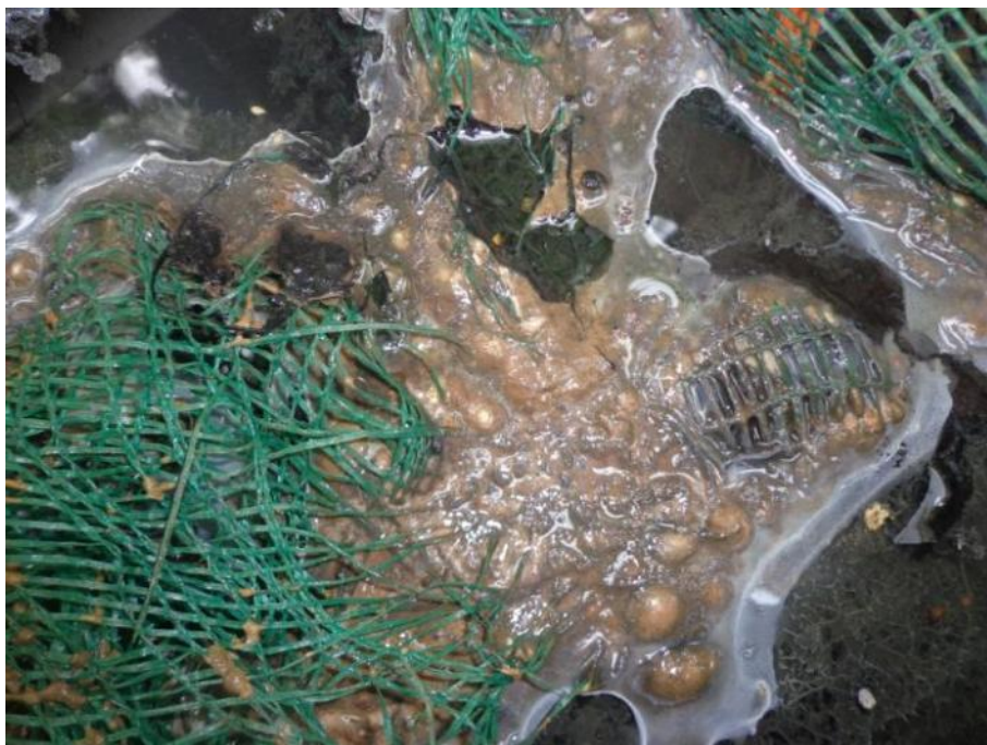
Figura 8.11. Imagens do biofilme aderido aos pedaços de entulho (envolto em um saco de ráfia verde) e de coco, no interior do filtro anaeróbio implantado em Pedra Branca.
