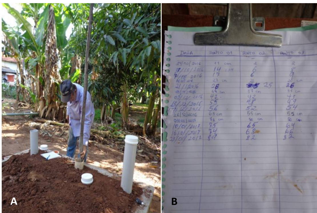
Figura 7.5. A) Nestor fazendo a aferição do nível do esgoto dentro da BET, no primeiro ponto de monitoramento. B) Anotações de campo com a altura da coluna d'água.
