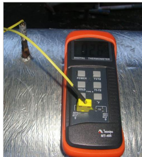
Figura 7-17: Detalhe da medição de temperatura (termopar e termômetro)
