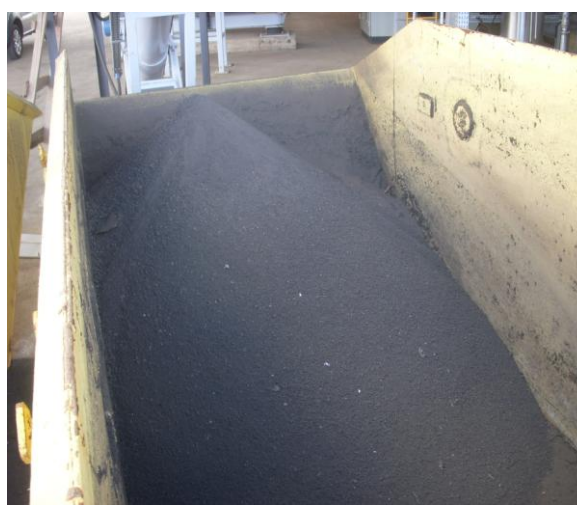
Figura 4-27: Lodo seco após a secagem térmica (teor de sólidos de 90%)
