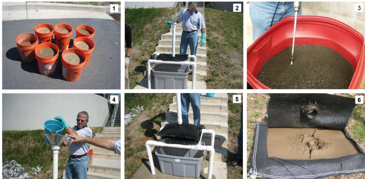
Figura 15 – Emsaio com tubo geotêxtil em escala reduzida 1- lodo separado para ensaio; 2- estrutura do ensaio; 3- homogeneização do lodo; 4- lodo sendo vertido para interior da bolsa; 5- deságue; 6- lodo desaguado após o ensaio.
