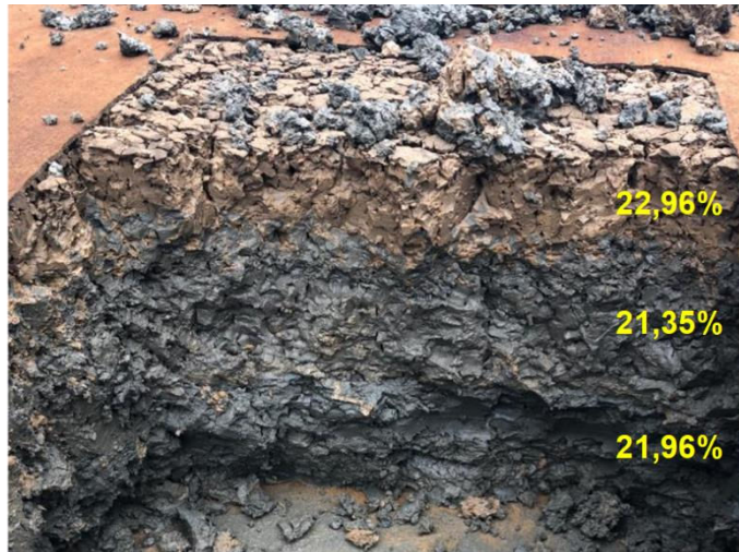
Figura 110 – Separação do lodo consolidado em camadas ao longo do perfil.
