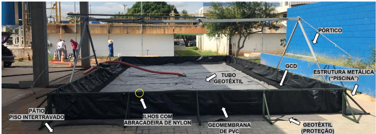
Figura 48 – Estrutura para monitoramento do tubo geotêxtil preenchido com lodo sem polímero.
