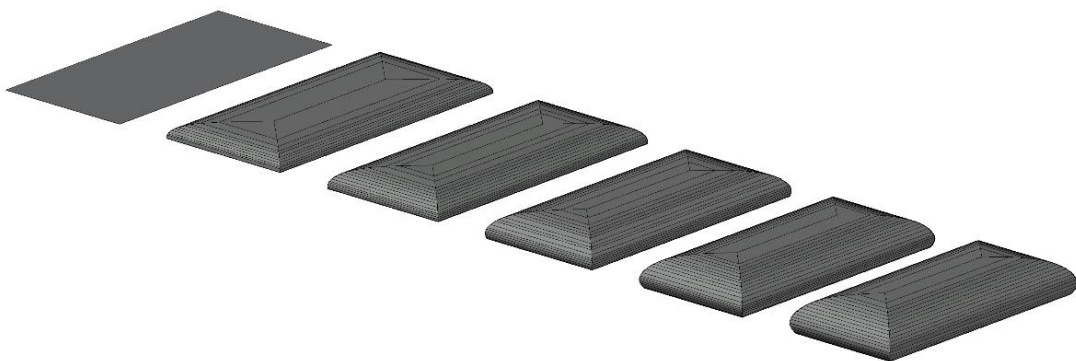
Figura 83 – Evolução do formato ao longo do enchimento.
