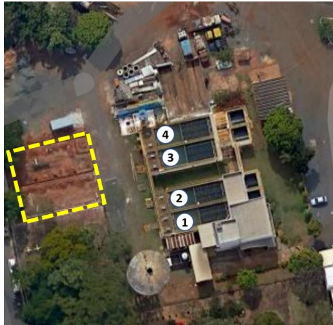
Figura 38 – Vista aérea ETA Bela Vista com numeração dos decantadores. Em amarelo, área de disposição dos tubos geotêxteis.
