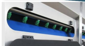
Um sistema automático de lavagem mantém a tela do filtro limpa usando bicos de spray especialmente projetados pela TEKNOFANGHI, que usam menos água que outros bicos padrão do mercado. Para limpeza rápida dos bicos, eles podem ser desmontados e limpos com facilidade, sem necessidade de ferramentas.
