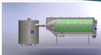
O parafuso de Arquimedes permite ajuste da concentração do lodo adensado, criando uma mistura contínua que ajuda a drenagem da água e minimiza o uso de polieléctrolitos. Como guia geral, lodo com 0,5%-3% pode ser compactado até 5%-15% de sólidos secos (DS).
