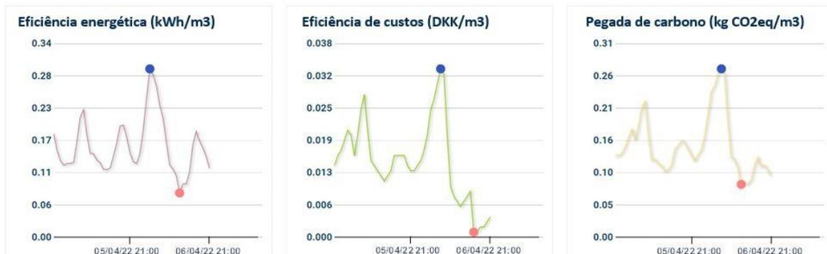
**Figura 18: Indicadores chave de desempenho para eficiência energética e de custos, e pegada de carbono da ETE de Egá. As tendências apresentadas são baseadas em sensores virtuais baseados em modelo.**
