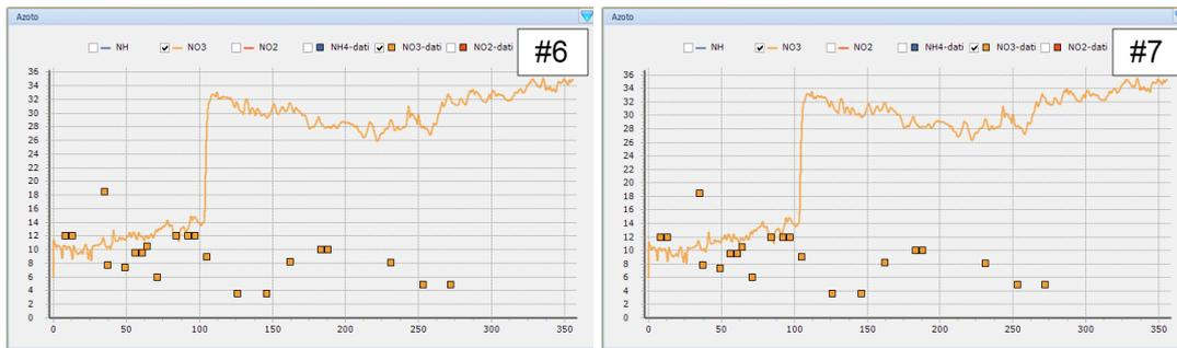
**Figura 7: Comparação da concentração de nitrato medida no efluente (pontos) e a predição do modelo (linha contínua).**
