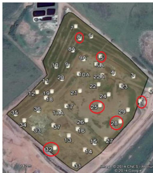
Figura 25. Aterro sanitário de Rio Claro com a disposição dos drenos de biogás
