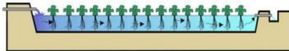
**Figura 6-** Estrutura básica de wetland, onde o afluente a ser filtrado e limpo é despejado pela tubulação de alimentação (à esquerda), passa pelas raízes da fileira de plantas, nas quais poluentes são retidos, convertendo-se em efluente tratado, o qual é direcionado à tubulação de coleta (à direita). Fonte: PMRJ, 2015.
